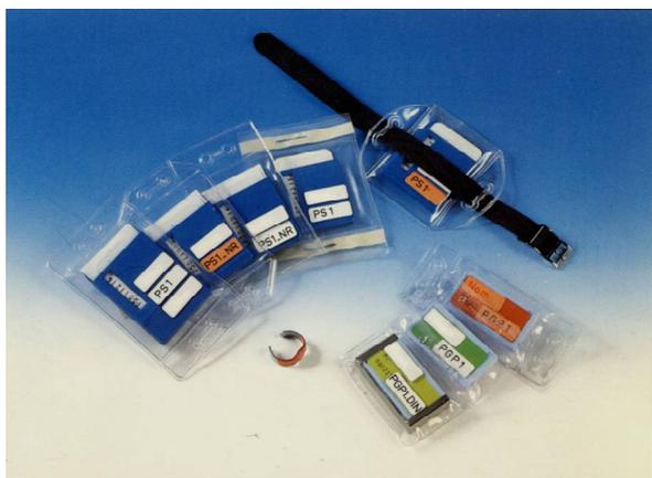
spécifique du CEA (le PS1). Ce dernier a remplacé le dosimètre initialement utilisé, insuffisant pour le CEA, et dont les anciens exemplaires ont été donnés au SCPRI qui lançait alors son laboratoire de dosimétrie du personnel. Le nouveau dosimètre PS1 a été utilisé pendant près de 45 ans au CEA Civil et militaire (jusqu'en 2007) ; ces études ont servi de base aux dosimètres utilisés à l'EDF et à la Cogéma.
